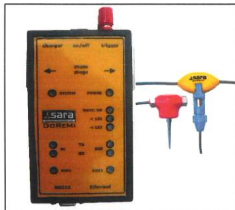
Figura 6. Sismógrafo DoReMi de la casa SARA Instrument
