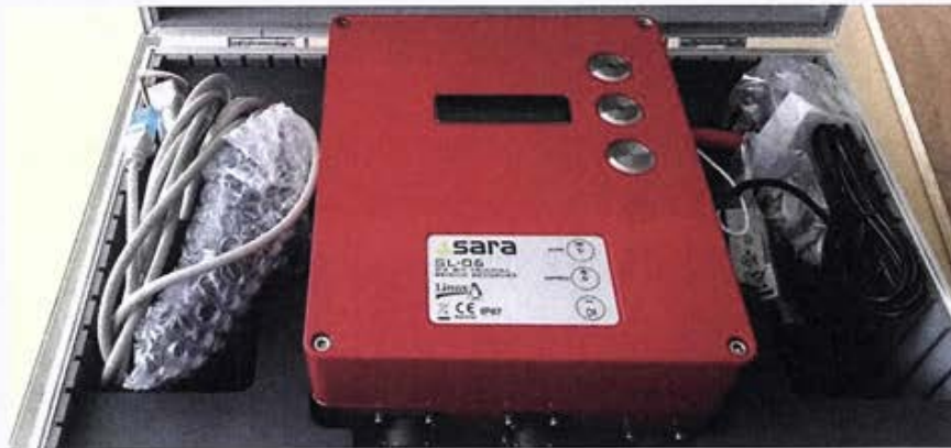
Figura 27. Acelerómetro triaxial de 4.5 Hz de frecuencia natural de la casa SARA Instruments.
