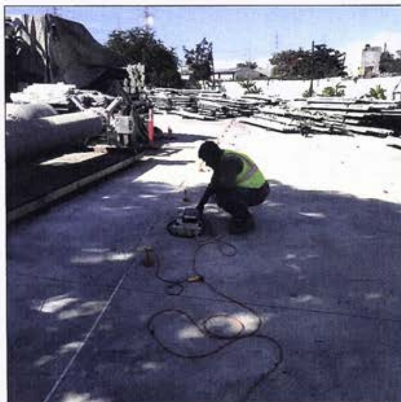
Figura 13. Perfil 2 visualizándolo desde el geófono 1 hacia el geófono 15, donde se encuentra el sistema de medida y registro de datos.
