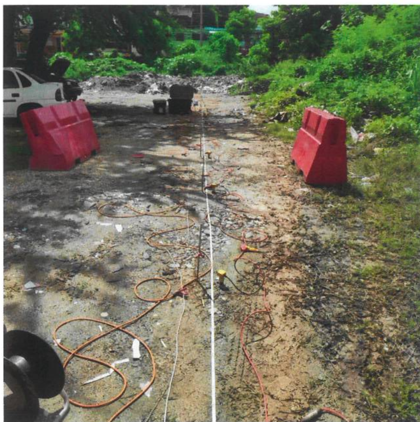
Figura 8. Perfil 1 visualizándolo desde el geófono 1 hacia el geófono 24, donde se encuentra el sistema de medida y registro de datos.
