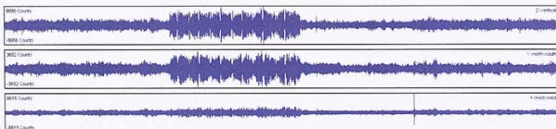
Figura 15. Señales sísmicas obtenidas a partir del acelerómetro triaxial
